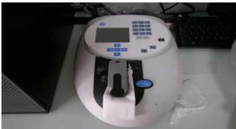
Figure 1 : Spectrophotomètre NANODROP
