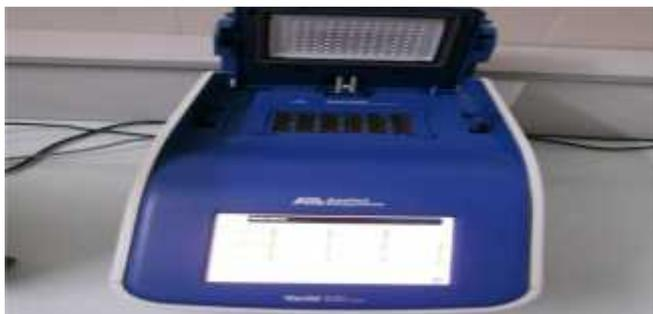
Figure 3 : Thermocycleur Applied Biosystem 2700
