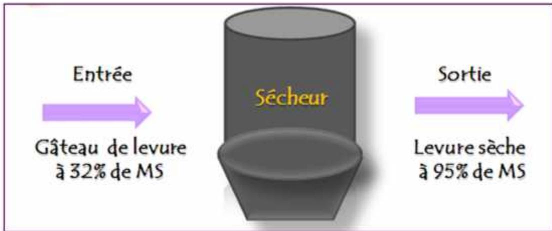
Puisque c'est la teneur en eau qui change, on peut donc établir un bilan de matière du sécheur, afin de pouvoir déterminer la quantité de levure sèche qu'on devait obtenir à partir des cuves de crèmes utilisées :
