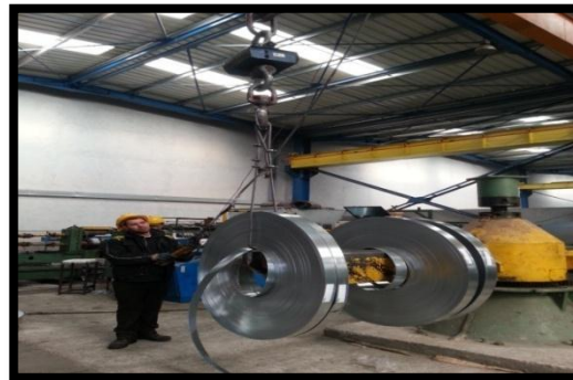
Figure I.9 : Transport des bobines et feuillards par pont roulant
