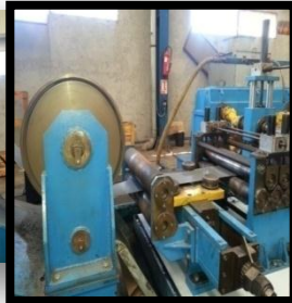
Figure I.14 : Feuillard guidé vers le premier bloc de formage
