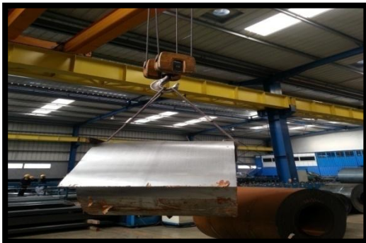
Figure I.9 : Transport des bobines et feuillards par pont roulant
