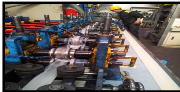
Figure I.16: Rôle du premier bloc de galets dans la machine tube (01)
