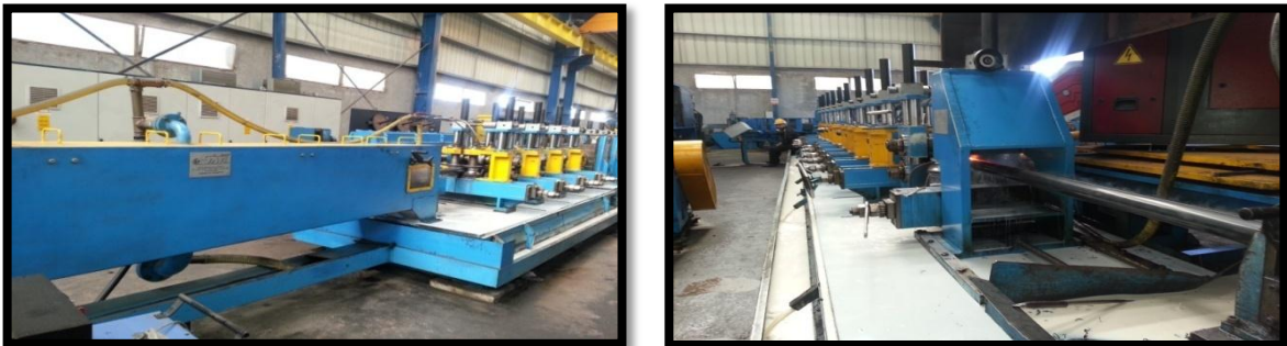
Figure I.19: Refroidissement et calibrage du tube
