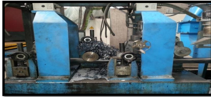
Figure I.18: Raclage cordant extérieur de soudure
