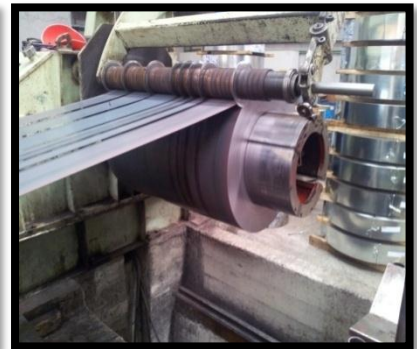
Figure I.8 : Enroulement des feuillards produits
