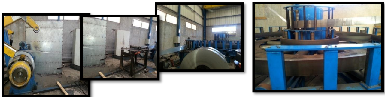
Figure I.12 : Alimentation du réservoir de feuillard
