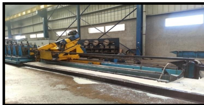
Figure I.20: Dispositif de coupe longitudinale du tube parvenant du bloc de calibrage.
