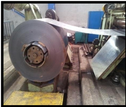
Figure I.6 : Déroulement de la bobine à refendre
