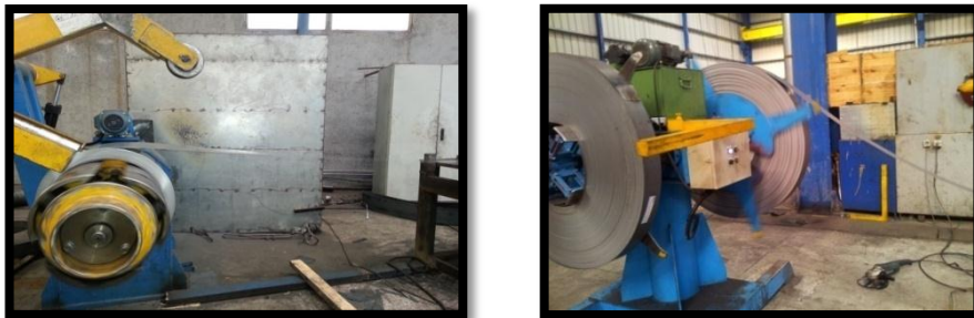
Figure I.11 : Feuillard déposé sur l'axe du dérouleur-machine tube 1
