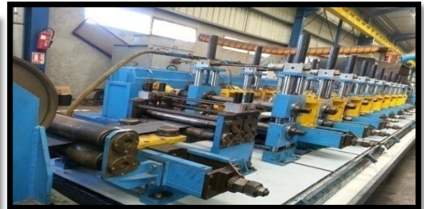
Figure I.15 : Insertion du feuillard dans le 1er bloc de Galets de formage
