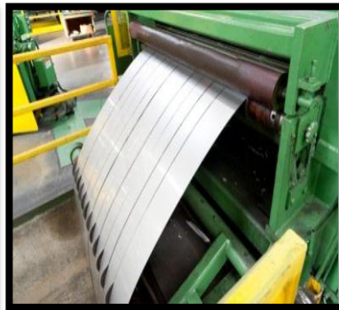
Figure I.7 : Refendage de la bobine par coupe
