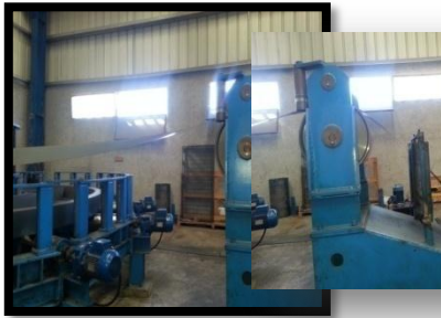
Figure I.14 : Feuillard guidé vers le premier bloc de formage
