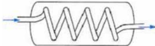
Figure 2-1 : Échangeur monotube en serpentín [3].
