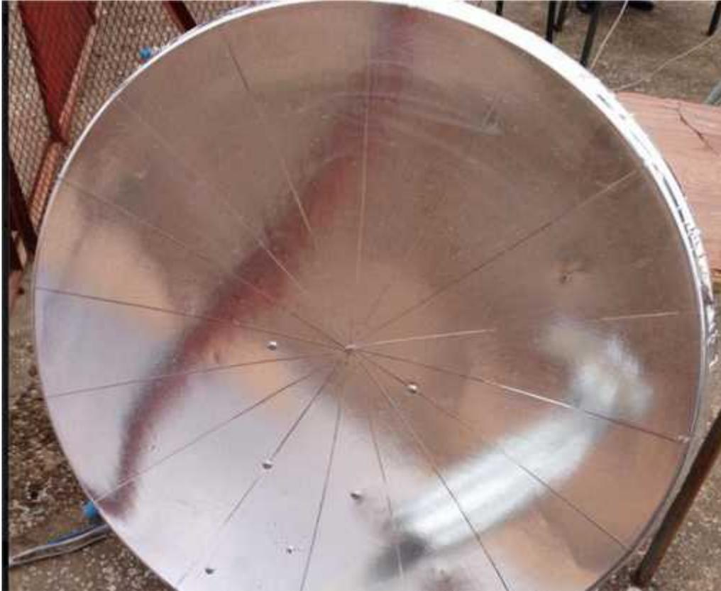
Figure 1-8 représente le concentrateur parabolique que l'on a obtenu.
