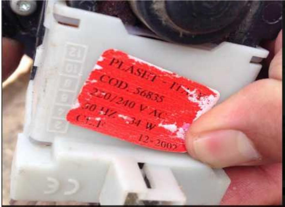
Figure 2-16 : .Les caractéristiques de la pompe
