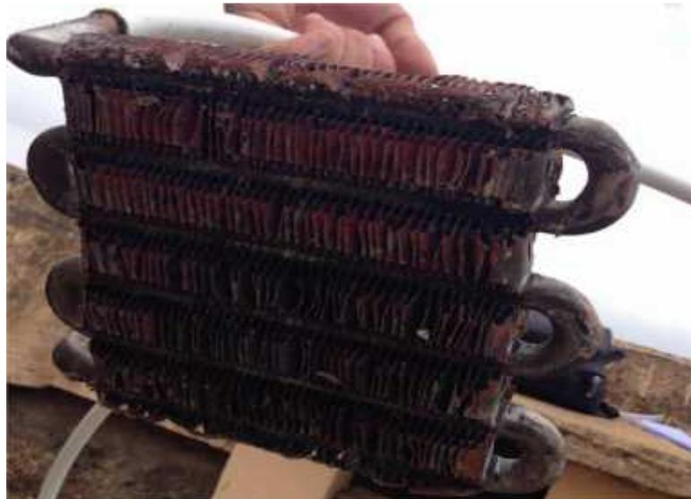
(Figure 1-9) : échangeur d'un chauffe-eau à gaz
