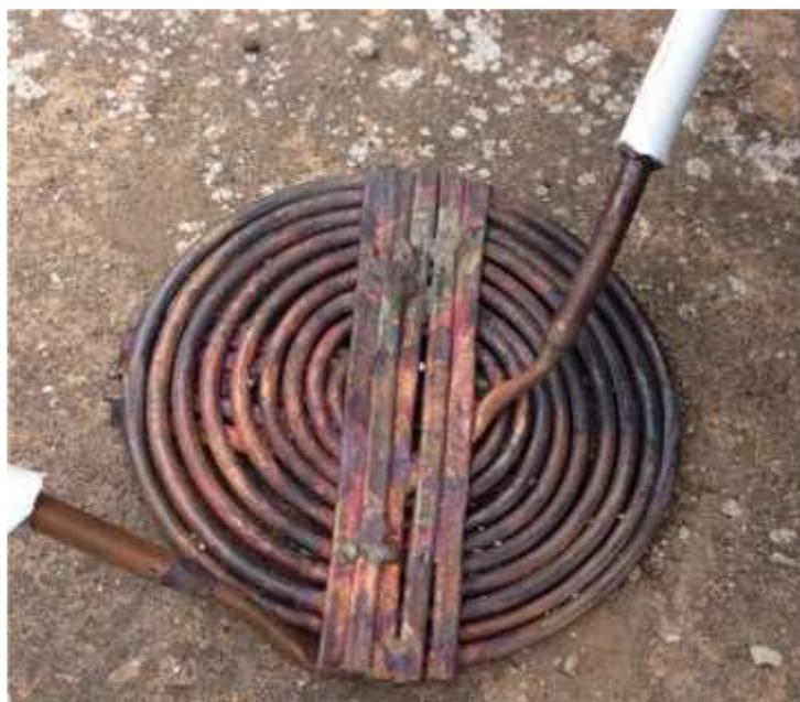
Figure 2-18 : un échangeur tubulaire en spirale
