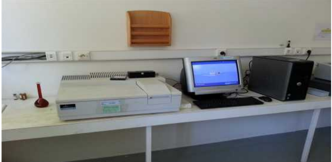
Figure 11 : Spectrophotomètre UV-Visible marque Perkin Elmer.
