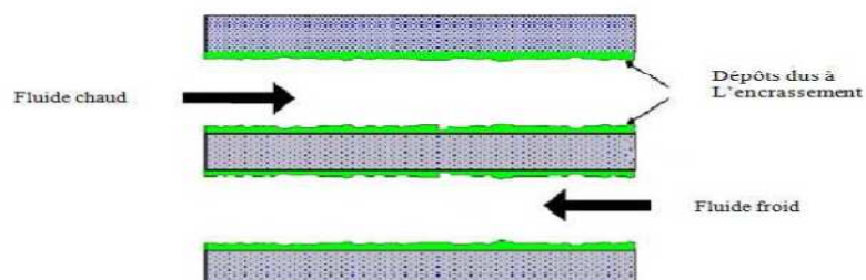
Figure 10 : schéma d'encrassement d'un échangeur
