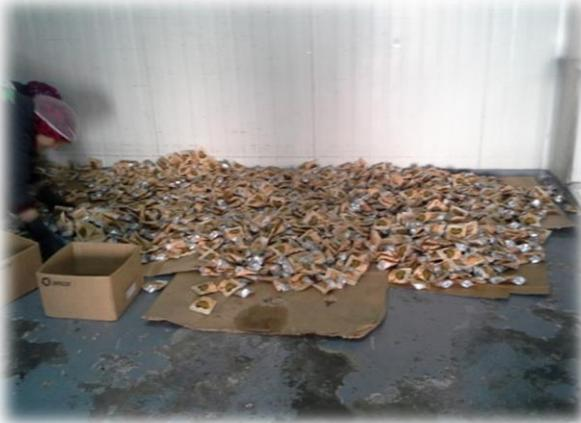
Eparpille des poches d'olives sur le sol pour l'élimination des traces d'eau sur les poches nécessite de vider les chariots sur le sol. Aussi après le séchage il nécessite que des employés le reprennent pour les mettre dans des poches et ceci constitue des gaspillages au niveau des mouvements du personnel.
