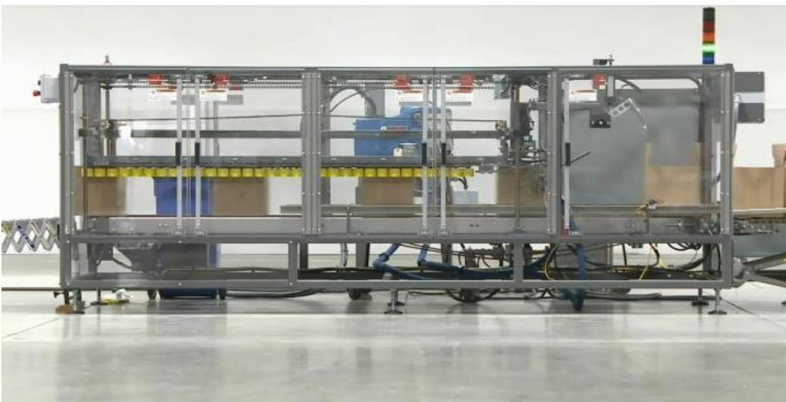
Figure 59: Photo montrant un exemple d'une encolleuse à caisse
