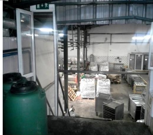
L'espace conçu au dessalage et égouttage reste toujours mouillé ceci est dû à une insuffisance d'égouts. Ce problème engendre un risque de glissement des opératrices de la zone.
