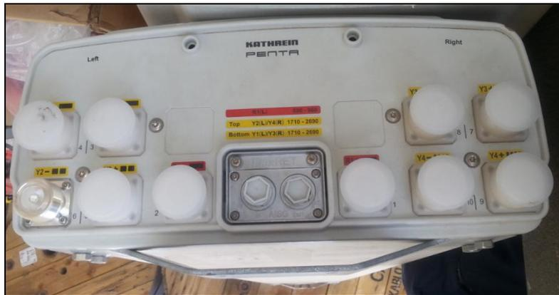
*Figure 28 : Les ports d'antennes Penta*
