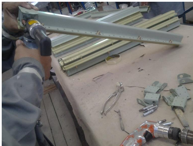
Figure 23: Rivetage des pièces dans le poste montage
