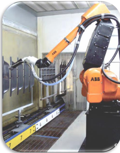
Figure 27: Exemple d'un bras robotique pour peinture à l'intérieur de la cabine
