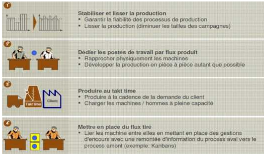
Figure n°9: Les 4 étapes de la mise en place du JIT
