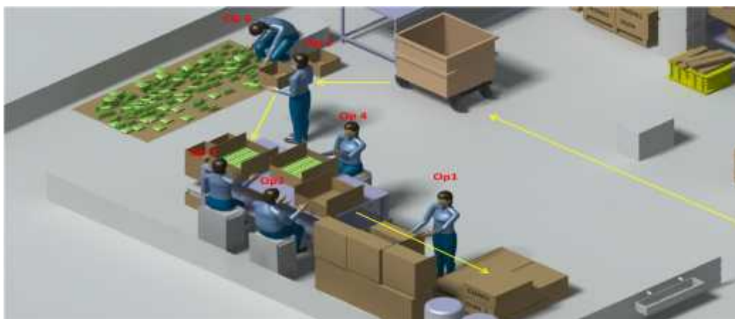
Figure n°57 : schématisation des postes de travail (zone conditionnement)
