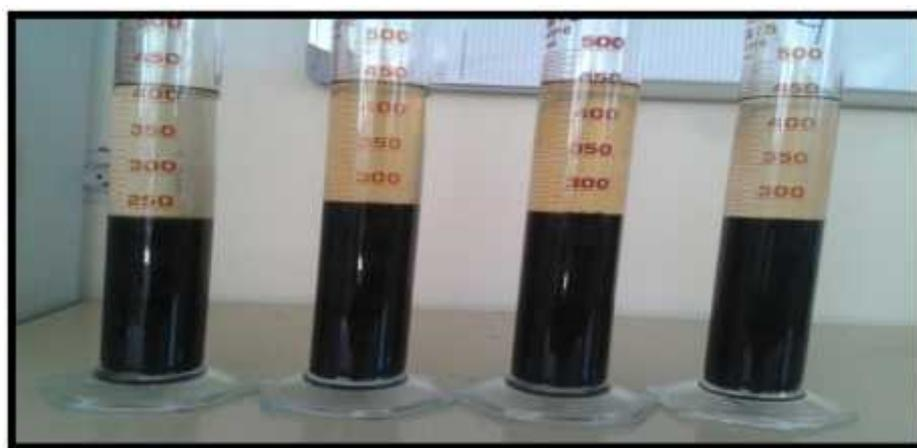
Figure 10: Volume des boues décantées dans le traitement au  $\text{FeCl}_3$
