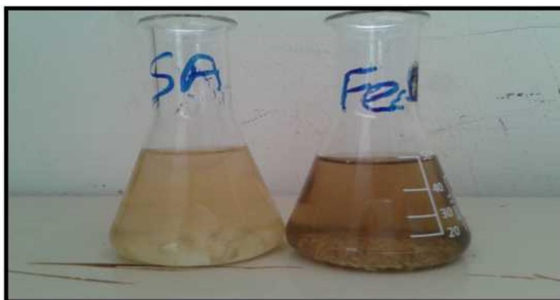
Figure 13 : Echantillons de margine traitée par le sulfate d'aluminium et le chlorure ferrique
