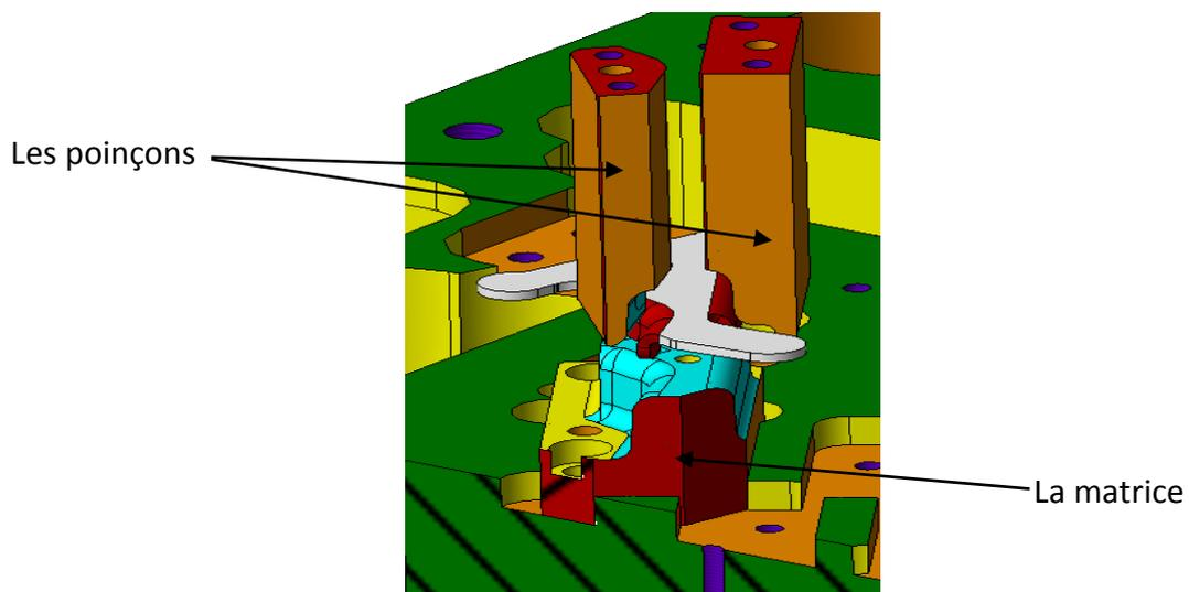
Figure 49 : réalisation des réactions forme complexe
