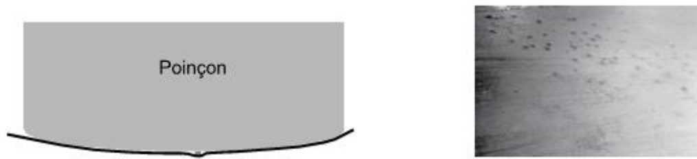
Figure 66 : Origine du picot (gauche) et très forte densité de défauts (droite)
