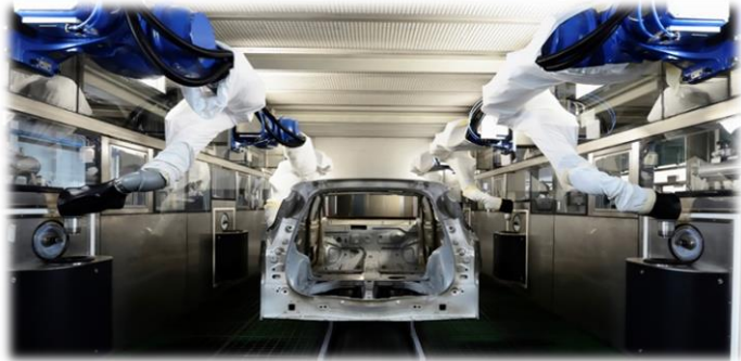
Figure 7 : Processus de peinture robotisé
