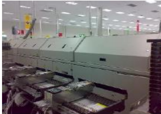
Figure 17 : Four de soudage
