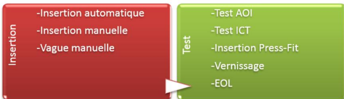
Figure 11 : Processus de production dans la zone Puissance
