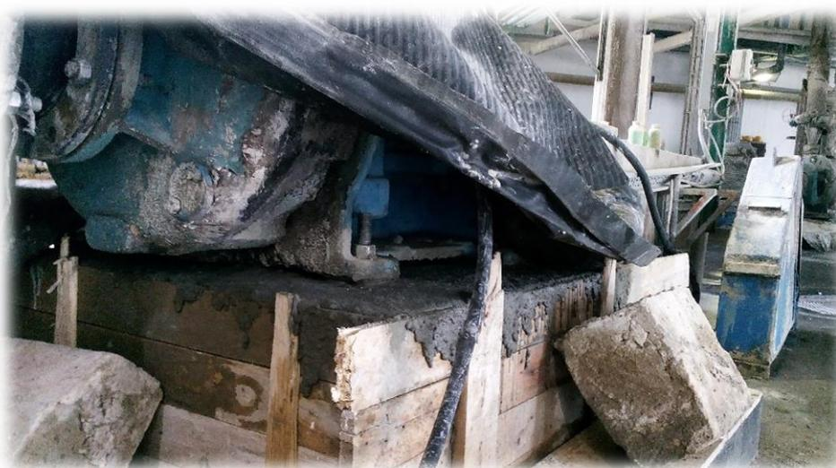
**Figure 19 :** Désalignement de l'arbre moteur-récepteur
