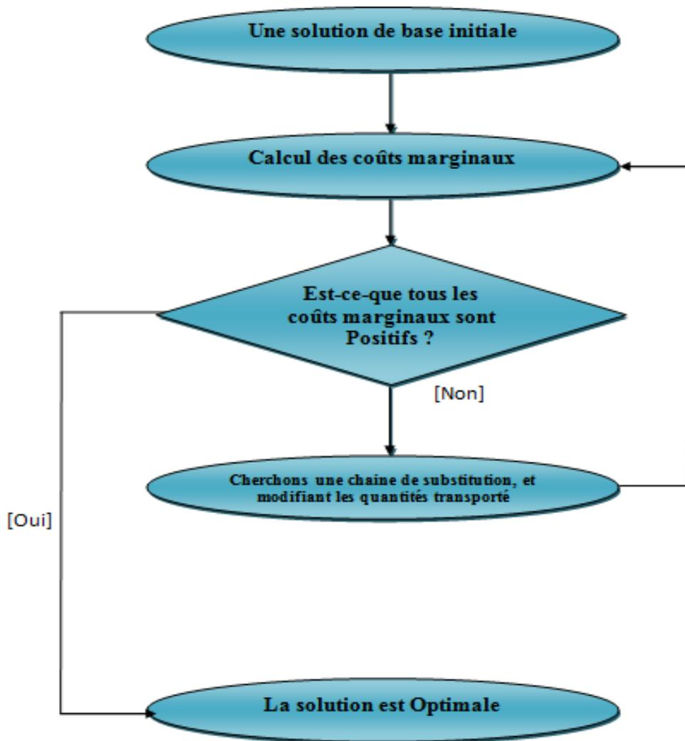
Figure 4: l'algorithme de Stepping-Stone.
