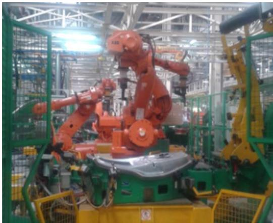
**Figure27:** Le robot de sertissage
