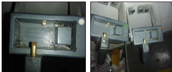
*Figure 3.2 : La poussière dans les chaines d'assemblage*
