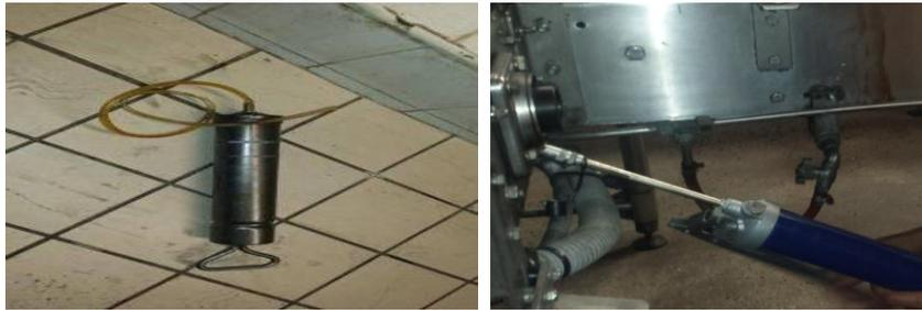
Figure 17 : Injecteur de graisse manuelle
