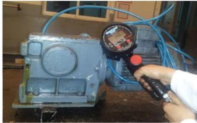
Remplir à l'aide d'une pompe à air le réducteur jusqu'au
