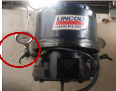
Au cas de disfonctionnement de la pompe automatique il faut attaquer le distributeur principal au niveau de graisseur LUB rep (b) par une pompe à air rep (c).
