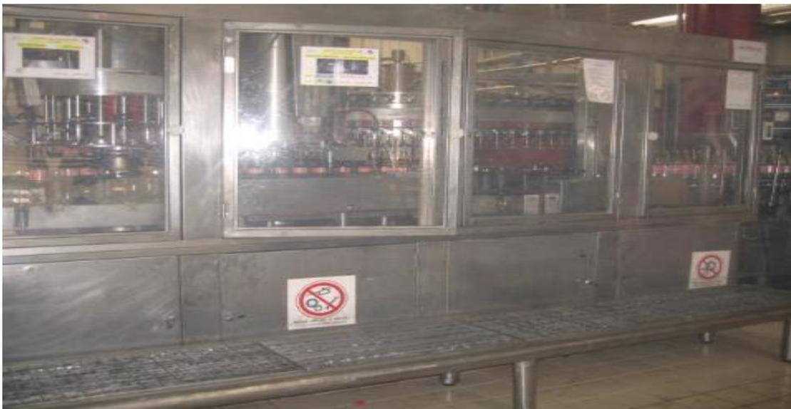
Figure 8 : Machine soutireuse de la ligne verre 4
