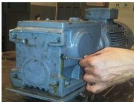
Etape 2: le niveau doit effleurer cette position (a), si le niveau est trop bas, rajouter de l'huile par le bouchon supérieure (b)
