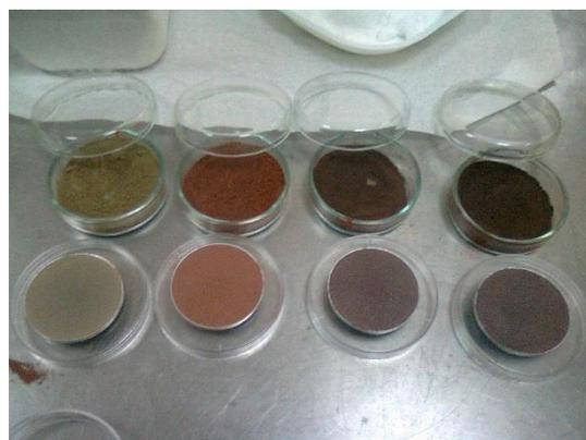
**Figure III-12.3** : préparations d'échantillon pour la fluorescence X
