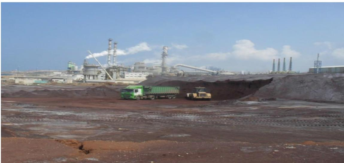
**Figure III-4.b :** Opération d'enlèvement des cendres de pyrrhotite dans des camions spécialisés mis à la disposition de l'OCP par des cimentiers marocains
