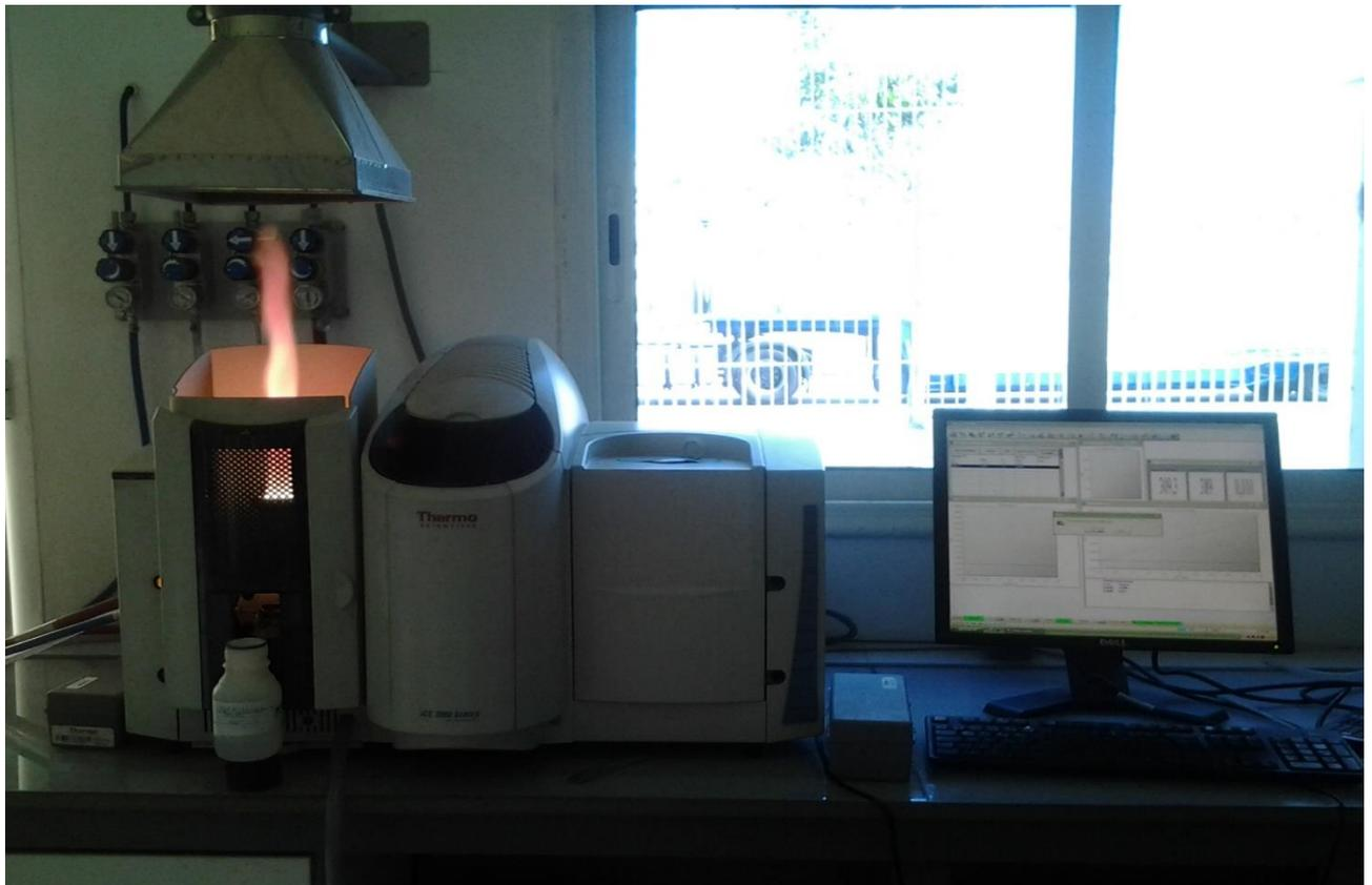
Photo 1 : Spectromètre d'absorption Atomique à flamme (SAAF) de type Thermo Fisher Scientific iCE 3500
