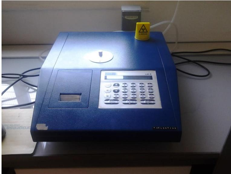
Photo 3 : Spectromètre de fluorescence XRF de type Oxford Lab-X 3000
