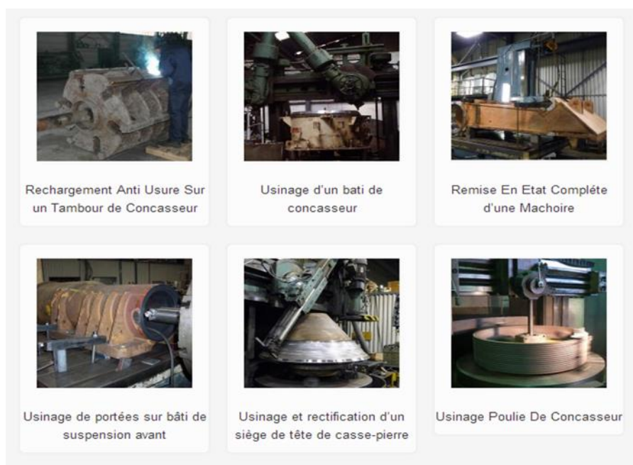
Figure 10: Réparation des concasseurs
