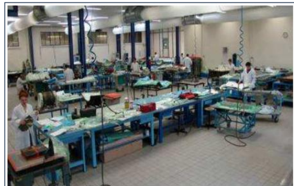
Figure 36: drapage dans l'usine
