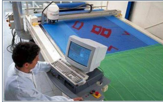
Figure 35: découpage du tissu par commande numérique
