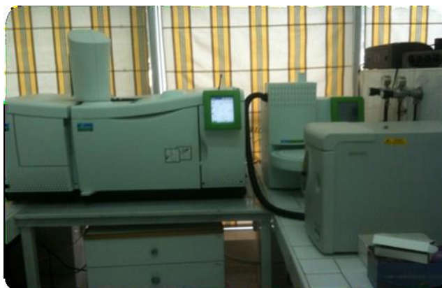
Figure 12: Appareillage de couplage CPG/SM (appareil du CAPM)
