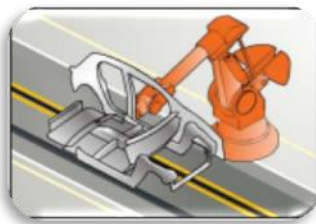
Assemblage des cotes de caisse
