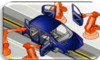
Démontage des portes
