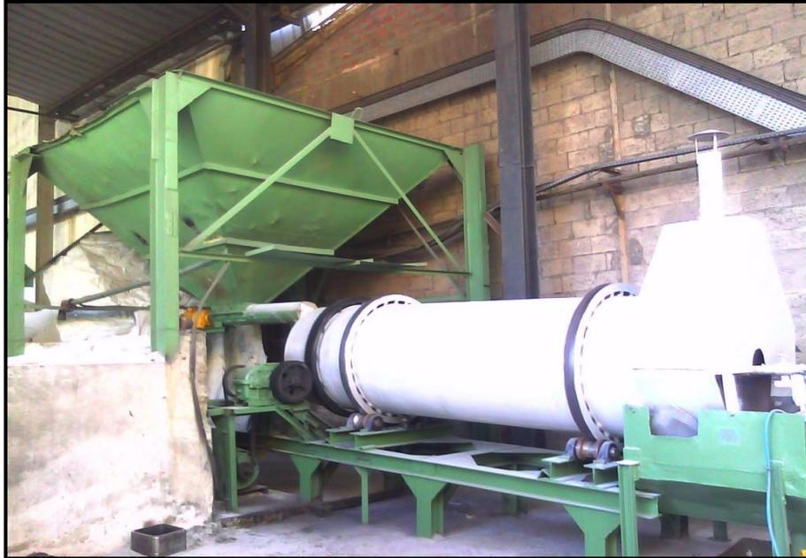
**Figure 11 : Sécheur à tambour rotatif**
