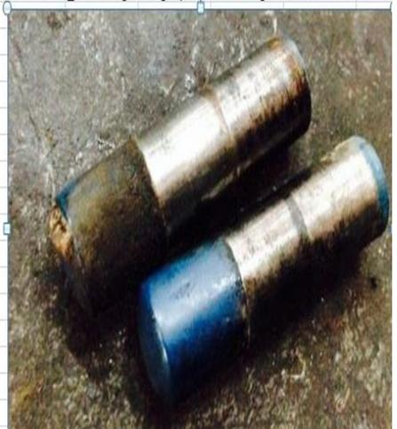
Démonter les arrêts de roulements
