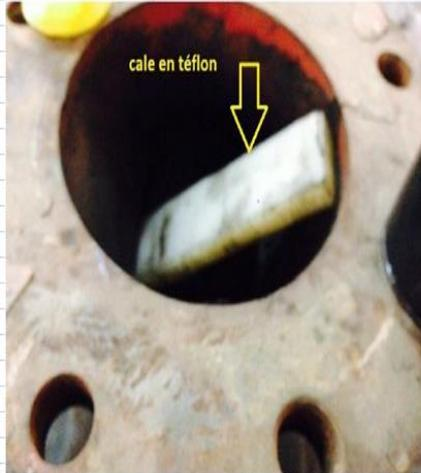
Desserrage des écrous à encoche de fixation des pignons
