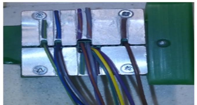
Figure 4.13 : La plaque métallique à mettre sur la contre-pièce du connecteur
