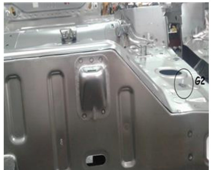
Figure 14 : emplacement des goujons en écarts dans l'unité arrière G5 et G2
