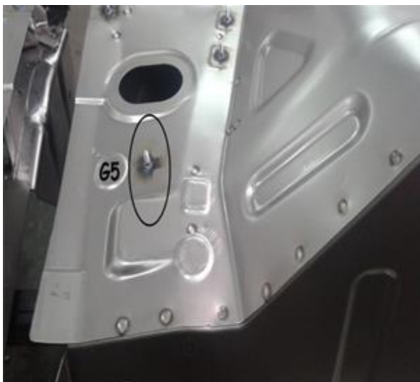
Figure 14 : emplacement des goujons en écarts dans l'unité arrière G5 et G2
