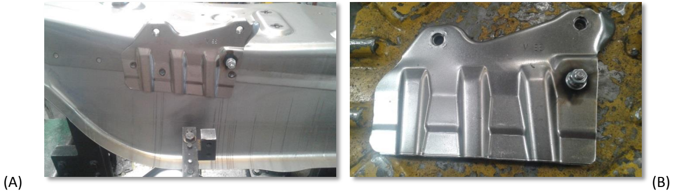
Figure 53: flasque traverse colonne avec goujon de masse
