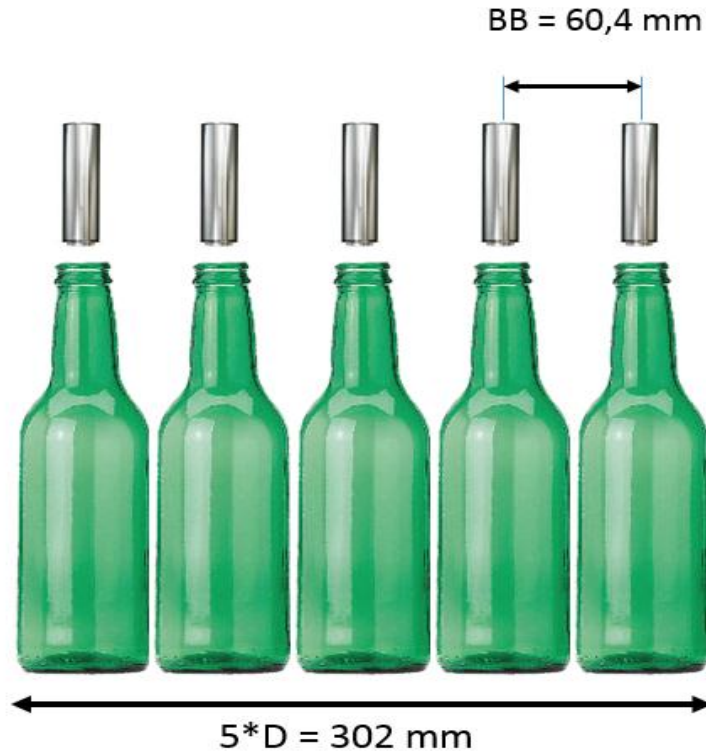
Figure 4 : Positionnement des bouteilles lors du remplissage
