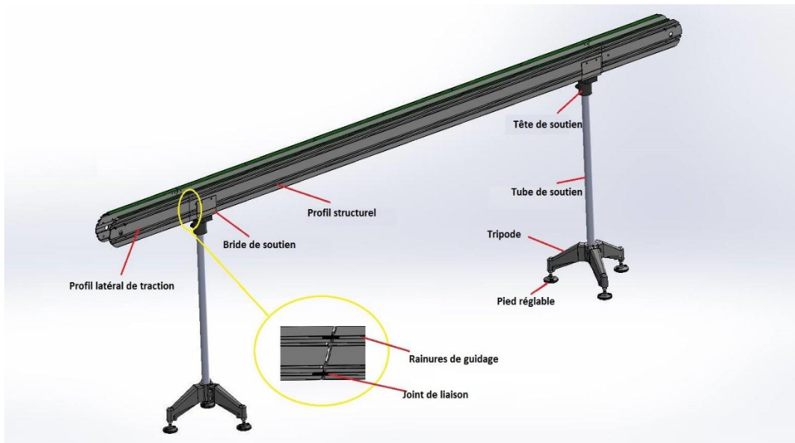
Figure 11 : illustration de la structure du convoyeur
