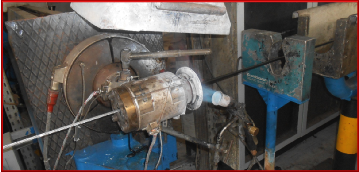
Figure 5: Extrusion du câble industriel
