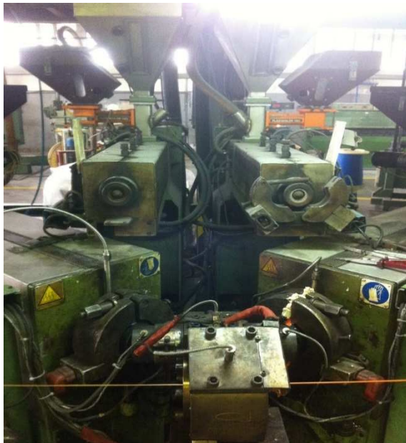
Figure 11 : L'état initial des deux extrudeuses auxiliaires
