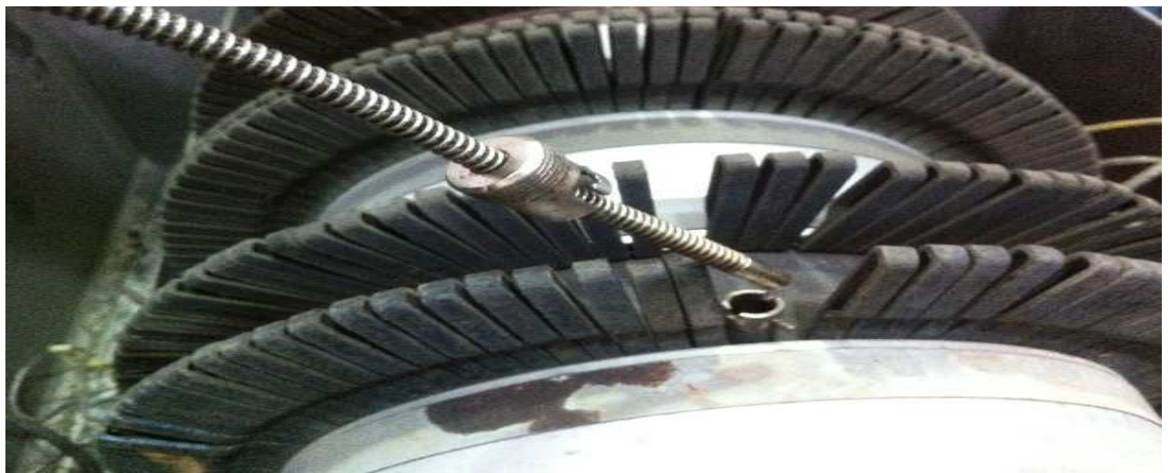
Figure25: résistances chauffantes du corps
