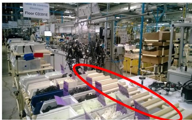
**Figure 27 : Racks d'alimentation de la chaîne d'assemblage**
