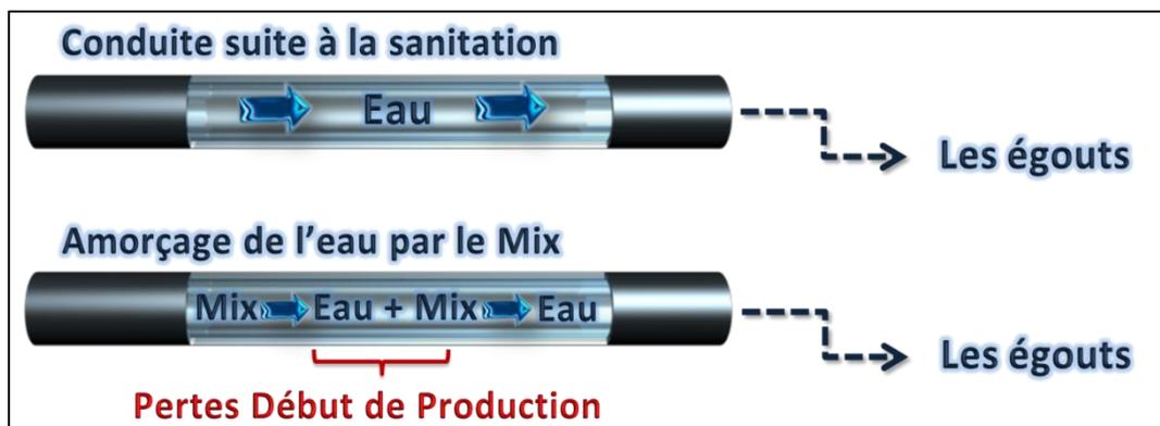
Figure 11: Schéma récapitulatif des pertes liées au Début de Production
