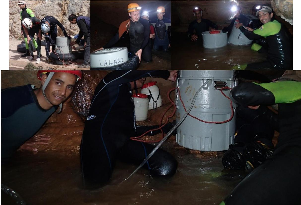
**Image29, 30, 31&32** : Lors de la préparation, du déplacement et de l'installation de l'auto-échantillonneur au sein de la grotte.
