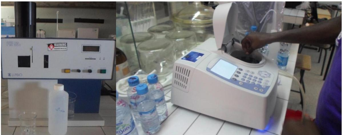
**Image 45 & 46** : Spectrophotomètre à U-V (à droite), et spectrophotomètre à flamme (à gauche).
