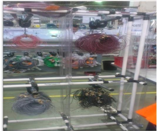
L'emplacement des joints du poste 10 n'est pas convenable, ce qui contribue au chevauchement des joints
