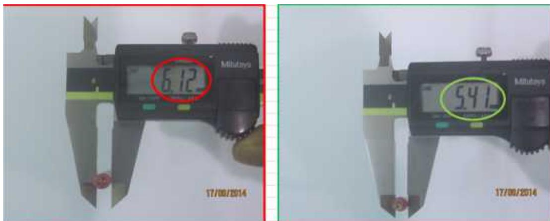
Figure 32 : Dimensionnel erroné dans le bouchon
