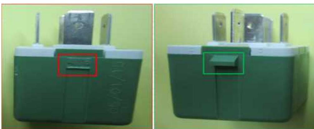
Figure 25 : Manque de matière dans le relai
