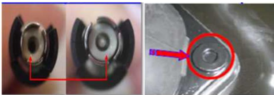
Figure 24 : support métallique avec un trou manquant
