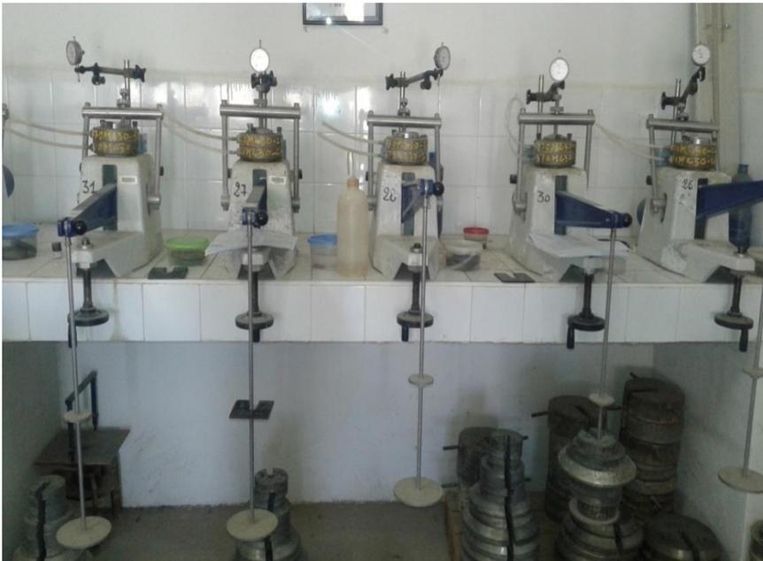
**Photo 9 : appareillage l'oedomètre**
