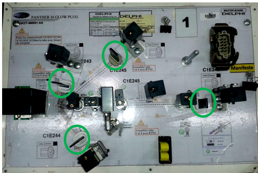
Figure 46: Pines métalliques indiquant la fin de bondage
