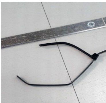
Figure 44: Bride explosée sous l'effet d'un pistolet mécanique
