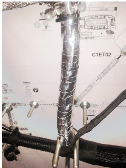
Figure 43: Bondage à l'aide du ruban d'aluminium sur les tubes d'aluminium
