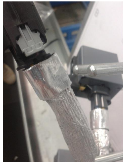
Figure 44: Fixation des extrémités des tubes à l'aide du ruban d'aluminium
