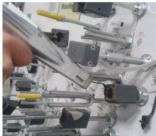
Figure 32: Difficulté de couper la lanière de la RTN39 correctement
