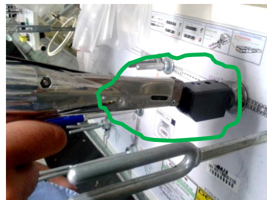
Figure 56: Coupe de la lanière de la bride RTN39
