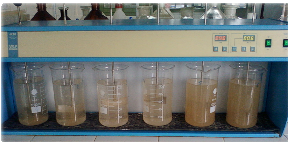
Figure 9: schéma de dispositif expérimental de l'essai de coagulation-floculation <<Jar Test>>
