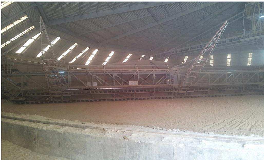
Figure 18 : Gratteur pré homogénéisation
