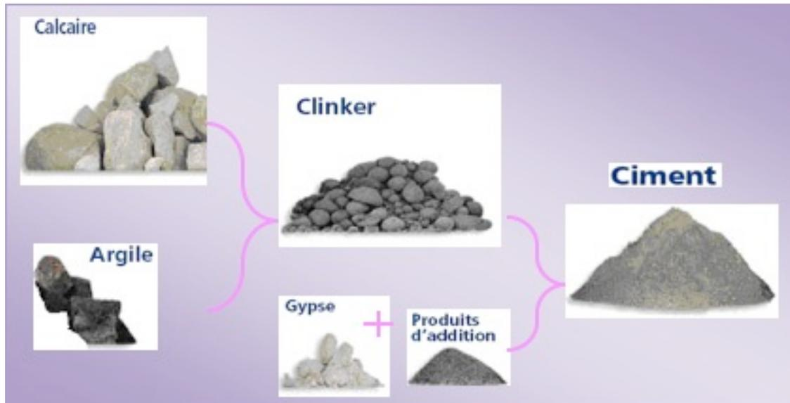
Figure 5 : Chaîne de transformation du calcaire et d'argile au ciments
