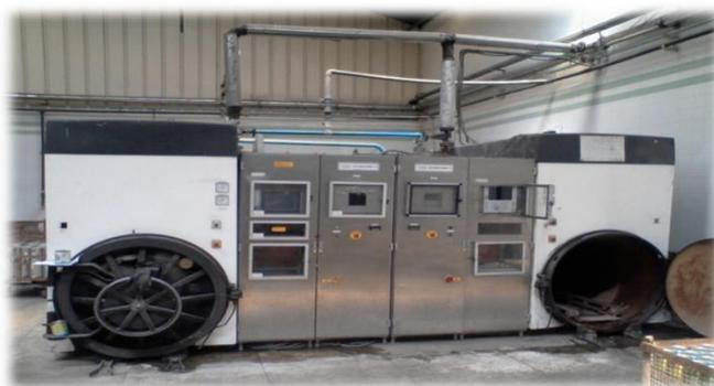
**Figure 11** : autoclave à double entré
