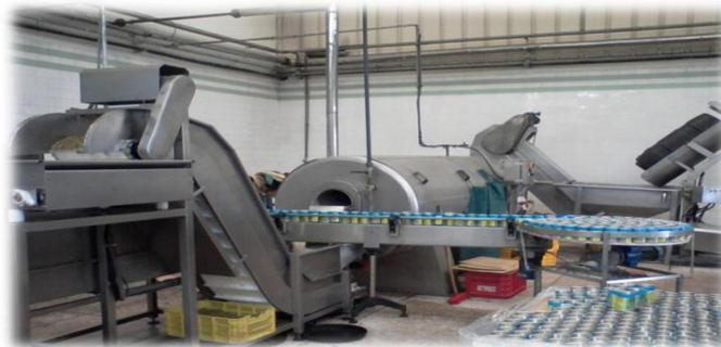
**Figure 10** : machine de blanchiment des olives
