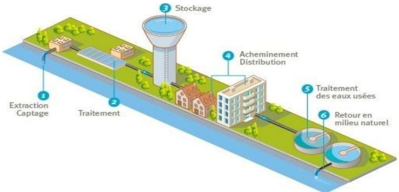
FIGURE 3 : Circuit de l'eau.
