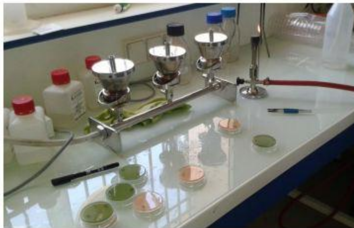
Figure 11 : méthode de filtration sur membrane.
