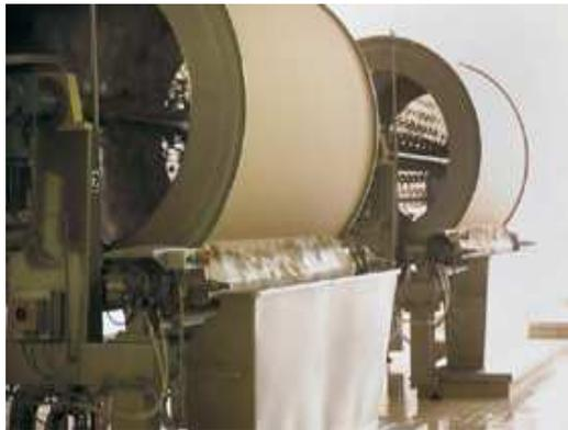
Figure n°2: **Filtres à vide rotatif**
