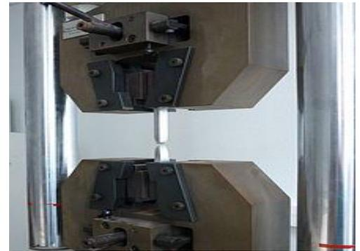
*Figure 3.2 : Essai de traction*
