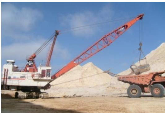
Photo 20 : Défruitage par dragline 200B
