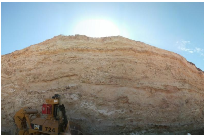
Figure 12 : Bulldozer qui creuse en profondeur suivant la continuité des couches affectées par la faille.
