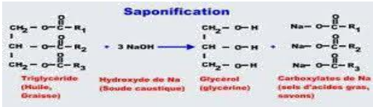
Figure 4 : Mécanisme de saponification
