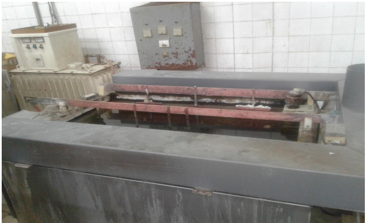
Image 14 : Bain de cuivrage alcalin
