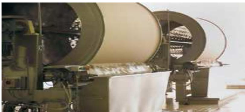
**Figure 8** : Filtre rotatif utilisé à la société Lesaffre pour la filtration de la crème .
