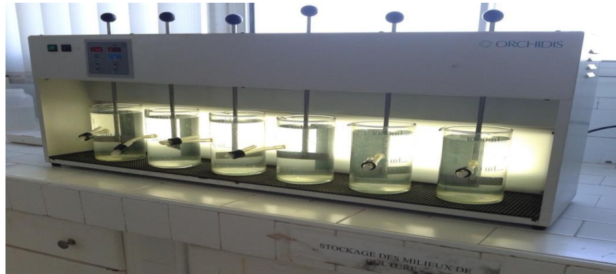
Figure 9 : Dispositif expérimental de l'essai de floculation (Jar-test)
