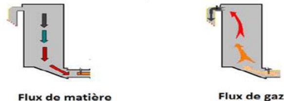
Figure 4 : Différents flux dans la tour de préchauffage
