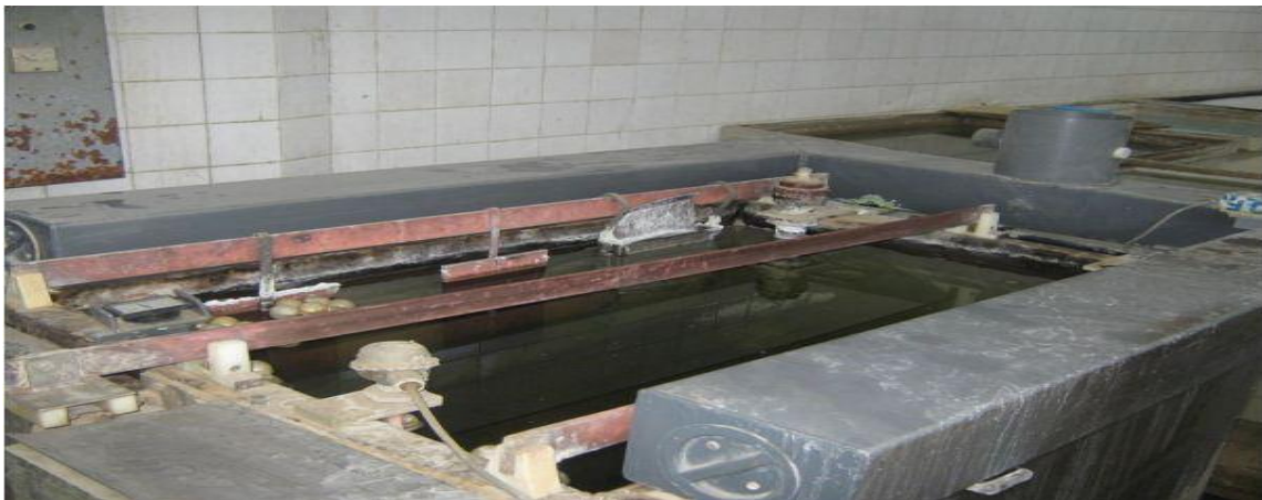
Image 20 : Bain de cuivrage alcalin
